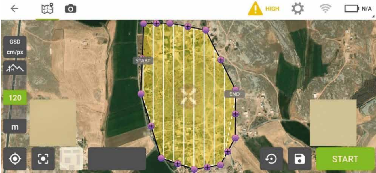
Şekil 5. Fotogrametrik uçuş planı / Photogrammetric flight plan
