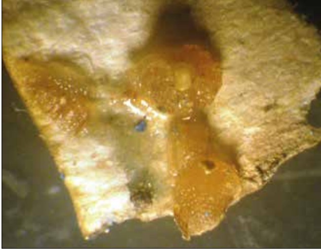
Resim 4: Sıva-kağıt arası birinci/üstteki kat yapıştırıcı (özgün)(solda), Sıva-kağıt arası ikinci/alttaki kat yapıştırıcı (onarım) (sağda) / First/upper layer adhesive between plaster and paper (original) (left), Second/lower layer adhesive between plaster and paper (repair) (right)
