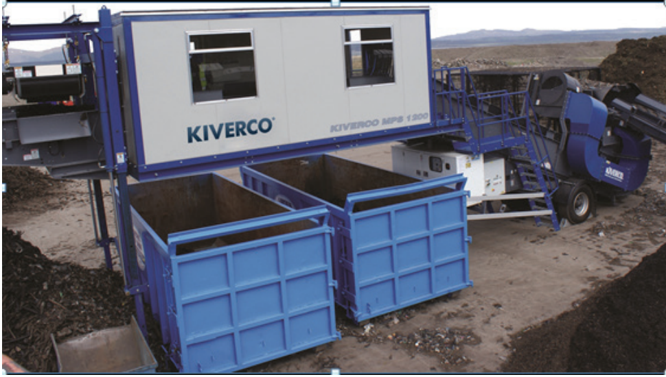
Şekil 7. El ile ayırma istasyonu yandan görünüşü (Kiverco Recycling Plant, 2023b)
