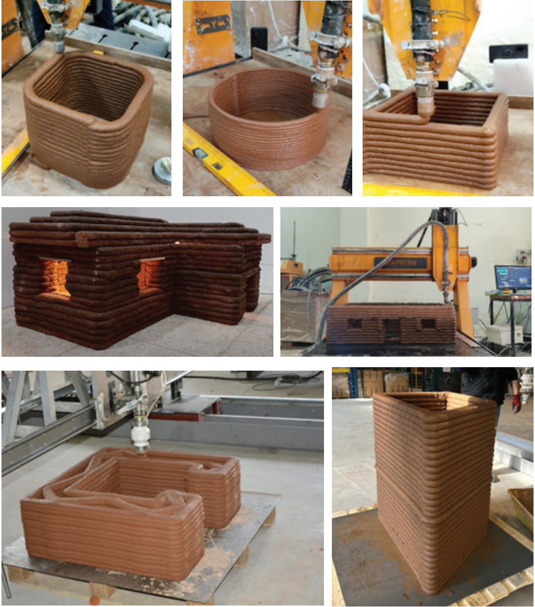
Şekil 17. İYA-bazlı jeopolimer beton ile üretilmiş 3B-Eİ ile gerçekleştirilen tasarımlar
