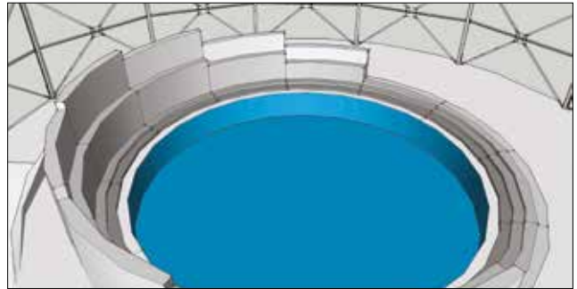
Şekil 9: Yükselerek kapalı havuz olarak kullanımı sağlayacak çeper duvarları (E. Türkel, 2017). / Outer walls rising up to form an indoor swimming pool (E. Türkel, 2017).
