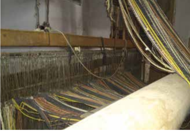
Fotoğraf 14 - Eski Tamzara bezi dokuma tezgâhında çözgü ipinin tezgâha çekilmiş hali / Warp thread drawn into loom on old Tamzara linen weaving loom (Fotoğraf için kaynak kişi / Source for photo: Mine CERANOĞLU) (Yıl /Year: 2013)
