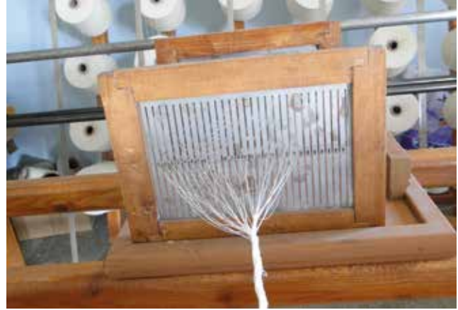
Fotoğraf 12- Çapraz tarağı / Cross comb (Tamzara Bezi Dokuma Atölyesi) (Fotoğraf için kaynak kişi / Source for photo: Arzu ARSLAN ) (Yıl /Year: 2016)
