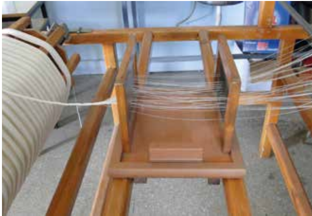
Fotoğraf 13 - Günümüzde hazırlanmış ve dolaba sarılmış çözgü ipliği / Warp threads prepared and wrapped on frame today (Tamzara Bezi Dokuma Atölyesi) (Fotoğraf için kaynak kişi / Source for photo: Arzu ARSLAN ) (Yıl /Year: 2016)
