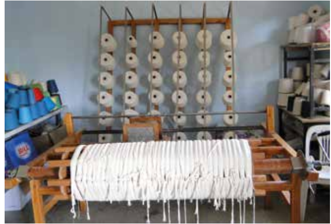
Fotoğraf 13 - Günümüzde hazırlanmış ve dolaba sarılmış çözgü ipliği / Warp threads prepared and wrapped on frame today (Tamzara Bezi Dokuma Atölyesi) (Fotoğraf için kaynak kişi / Source for photo: Arzu ARSLAN ) (Yıl /Year: 2016)
