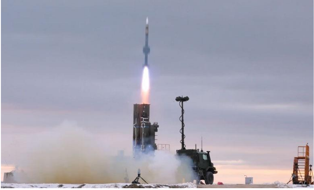
Şekil 2. HİSAR O+ sisteminin ilk RF (Radyo Frekansı) arayıcı başlıklı test füzesi atışı
